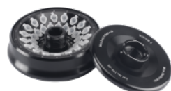
18G A-3角式转头 0.5ml×36孔 15000rpm/16350×g
