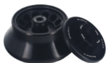
18G A-4角式转头 5ml×12孔 16000rpm/18890×g
